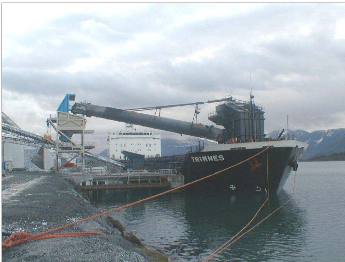
Figur 5-3 - Eksempel på bulkskip for pukk og stein (ut) og for befuktet flyveaske og bunnaske (inn) - (fra anlegget CSL's MS Trimnes selvlosser)
