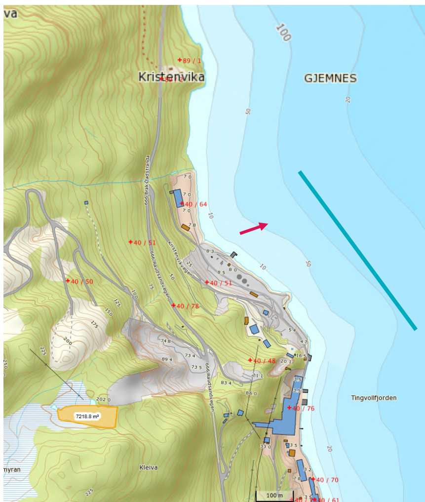
Figur 3-9 - Bunnterreg og utslippspunkt. (blå linje – antydnet utjevnet bunn etter utfylling, rød pil – utslippsledning)
