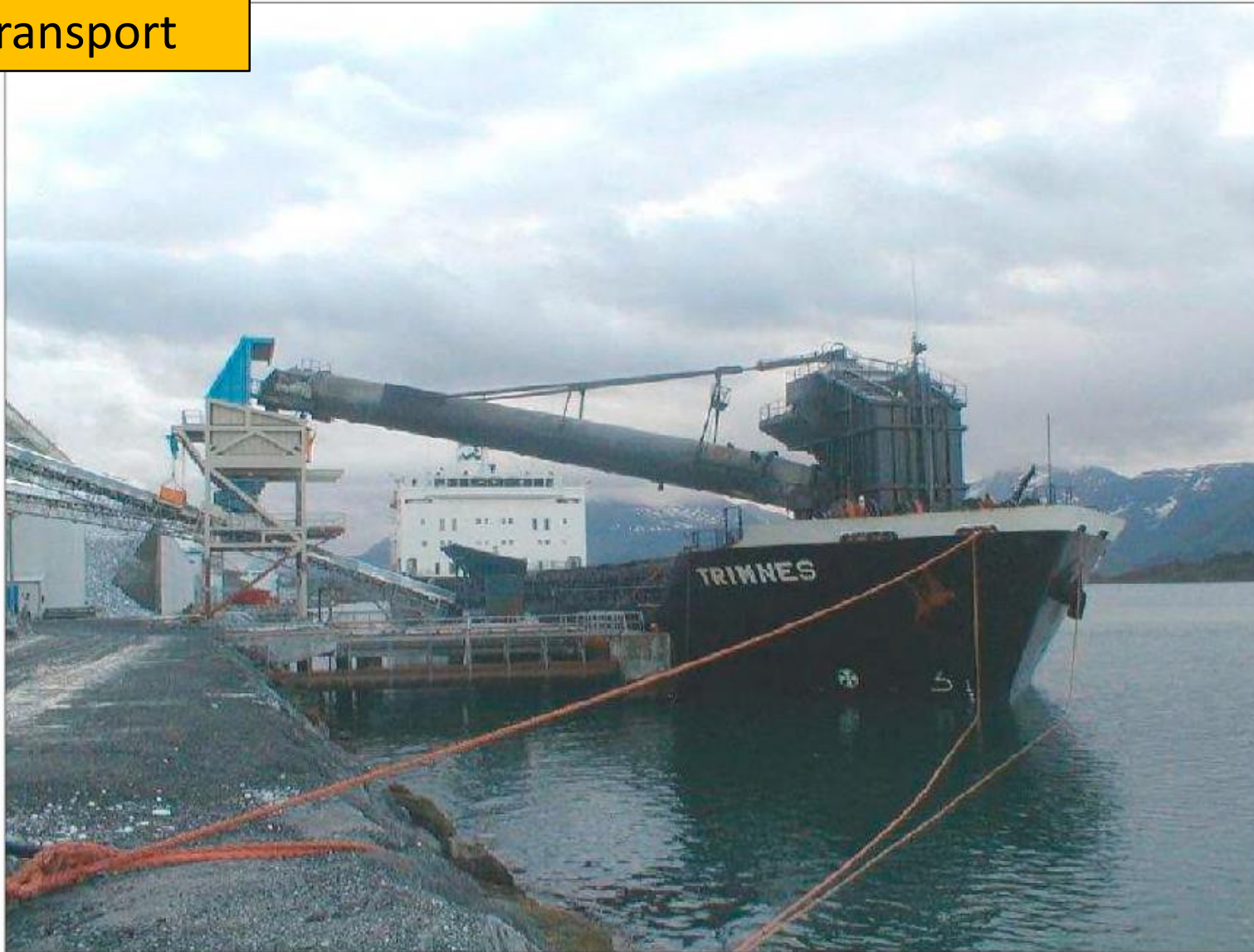
Figur 5-3 - Eksempel på bulkship for pukk og stein (ut) og for befuktet flyveaske og bunnaske (inn) - (fra anlegget CSL's MS Trimnes selvlosser)
